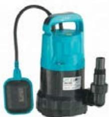
Drainagepumpe LEO der Reihe **XKS- P** ist eine Pumpe mit Gehäuse aus Kunststoff mit Ansaugung durch Schlitzsiebe, Schwimmerschalter und 10 m Kabel. Laufräder aus Noryl, Körnung der Festkörper max. 5 mm, Eintauchtiefe max. 7 m, 230 V/50 MHz. Zur Absaugung von leicht verschmutztem Wasser aus Brunnen, Schwimmbecken oder sonstigen Wasserflächen.
