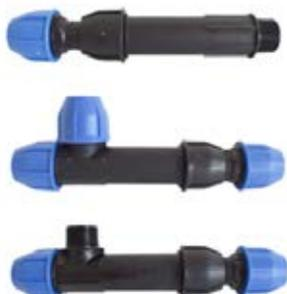
Verlängerungsformstücke NORMA sind aus PP gefertigt und für PE-Rohren, für Wasserdruckleitungen bestimmt. Einfache und schnelle Reparatur eines beschädigten Schlauchs mittels einer Gleitmutter an dem Formstück. Druckreihe PN12.5 für Formstücke bis Durchmesser 50 mm. Formstücke finden Anwendung in der Landwirtschaft, Industrie und auch für private Zwecke. Sie sind nicht für Warmwasserleitungen bestimmt!
