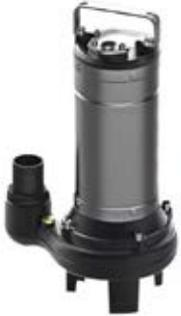
Pumpen der Reihe **LSW** sind einphasige Abwasserpumpen bestimmt für das Pumpen von Wasser aus Faulgruben, kommunalen Kläranlagen, Entwässerungssystemen und auch für industrielle Zwecke. Pumpen sind mit Schneidmesser und Schwimmerschalter ausgerüstet. Pumpengehäuse ist aus Gusseisen und Edelstahl.
