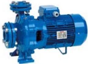
Pumpen Speroni der Reihe 2CM sind horizontale selbstansaugende Kreiselpumpen mit zwei Laufrädern. Max. Saughöhe 7 m. Geeignet für mittelgroße und große Bewässerungsanlagen, Bewässerung im Gartenbau und Landwirtschaft, für industrielle Zwecke zum Fördern von reinem Wasser und nichtaggressiver Flüssigkeiten.
