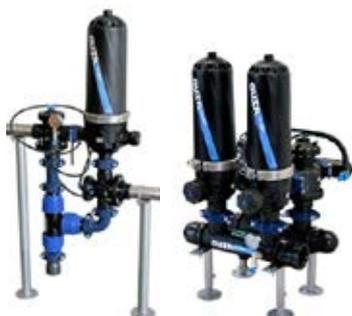
Automatische selbstreinigende Filteranlagen mit Scheibenfiltern AZUD Helix System. Steuerung der Selbstreinigung sichert das Steuergerät Azud FBC, der Typ hängt von der Filteranzahl ab. Optional 1-Filter-Modul mit Unterbrechung der Wasserzufuhr während der Selbstreinigung oder Mehr-Filter-Modul mit ununterbrochener Wasserzufuhr. Für gegebenes Projektes empfehlen wir die optimale Filteranlage.
